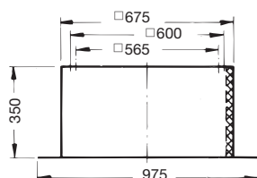
Stahl-Glattdach-Sockel mit Innenisolierung
